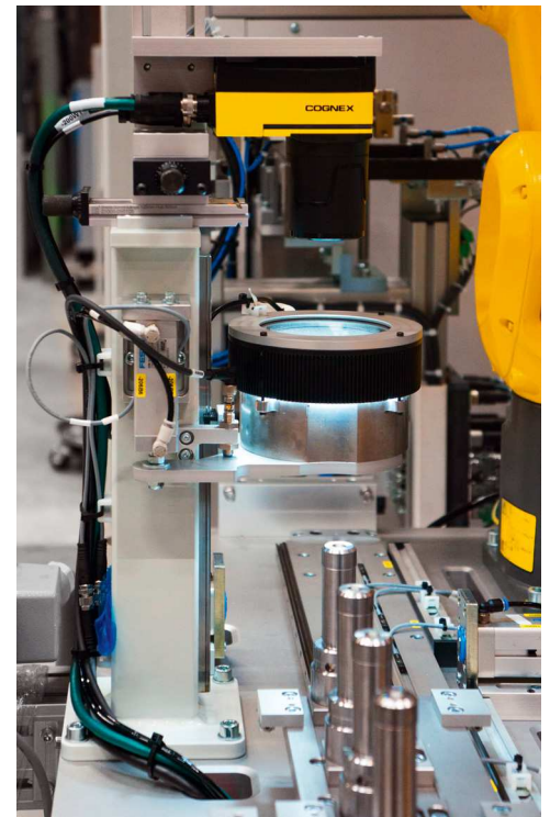
Bild 4. Die Kamerastation mit noch unbestückten Aufnahmedornen des Querschlittens. Der silberne Zylinder unter der großen Linse enthält die selbst entwickelte Spezialoptik für 360°-Aufnahmen. © Robotec
