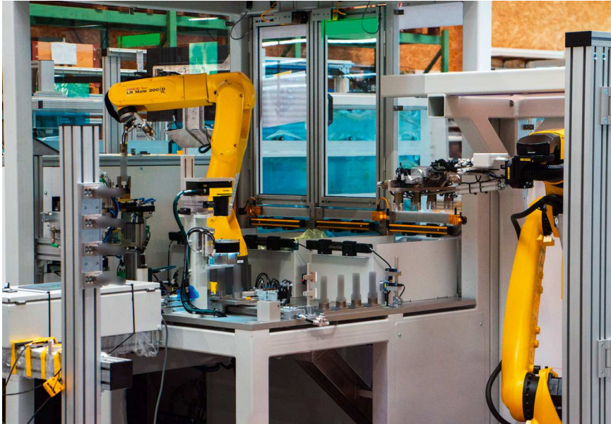
Bild 3. Vier Bolzen mit fertig umspritzten Hülsen an der quadratischen Alu-Säule (links) repräsentieren die Kerne der Form. Roboter „2“ bringt gerade vier Endprodukte zum Querschlitten der Kamerastation. © Robotec
