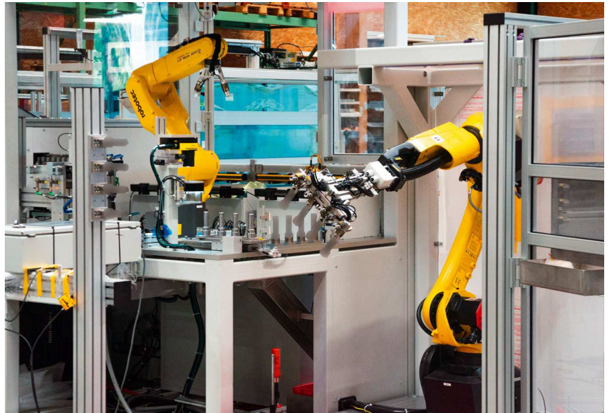
Bild 2. Eine neu entwickelte Handling- und Prüfstation für einen Automobilzulieferer. Roboter „2“ holt mit seinem Doppel-Vierfachgreifer gerade vier Rohlinge ab, um sie anschließend gegen fertig umspritzte Bauteile auszutauschen. © Robotec
