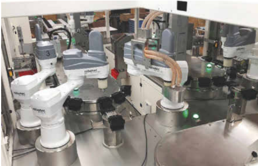
Anlage zur Prüfung, Bestückung und Verpackung von in 96er-Trays aufgereihten Pipetten für die Labordiagnostik
