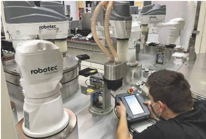
Drei der insgesamt sieben Roboter in der Reinraum-Zelle, die alle neun Sekunden 96 geprüfte, mit Filter bestückte und fertig verpackte Pipetten ausgibt
