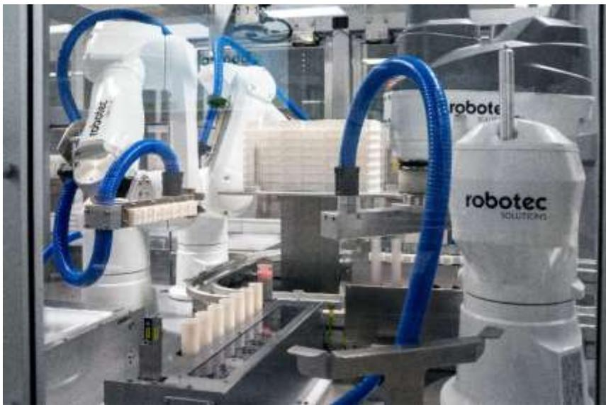
Trois robots poly articulés et trois robots SCARA sont utilisés dans cette solution robotique de Robotec Solutions.
