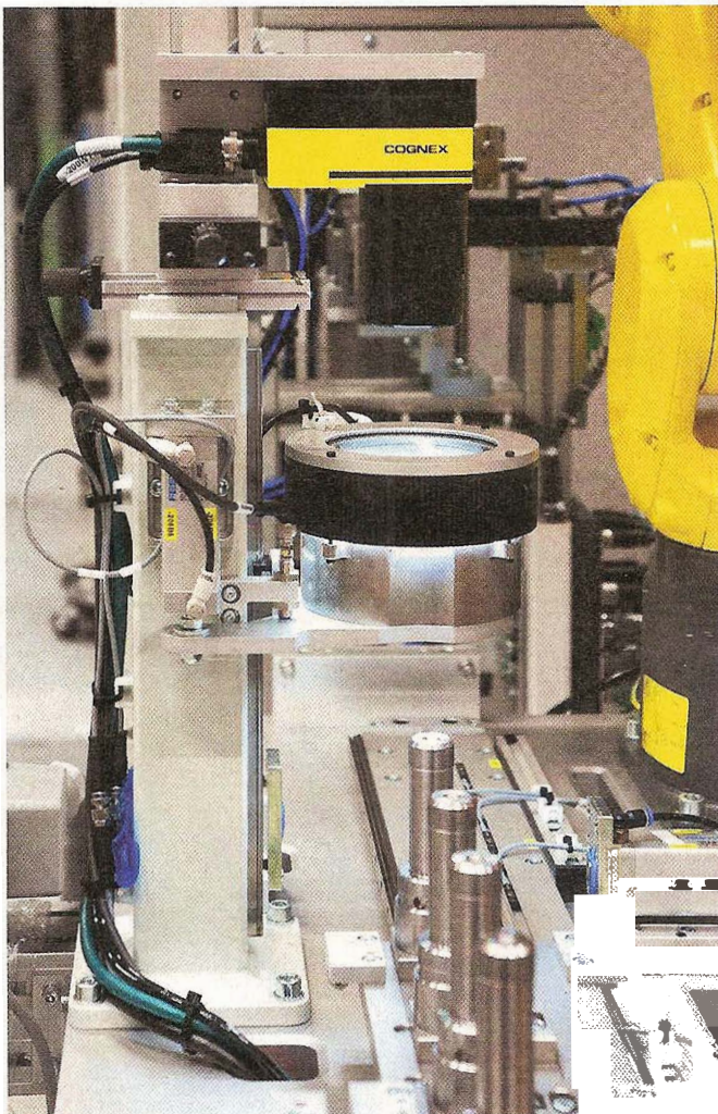
Die Kamerastation mit noch unbestückten Aufnahmedornen des Querschlittens. Der silberne Zylinder unter der großen Linse enthält die selbst entwickelte Spezialoptik für 360°-Aufnahmen.
