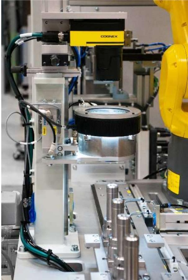
La station vision, avec les mandrins de prise de vue (encore non équipés de pièces) montés sur une table linéaire transversale. Le cylindre argenté, placé sous l'éclairage annulaire, contient l'optique spéciale développée en interne pour les prises d'images à 360° (Copyright: Robotec)
