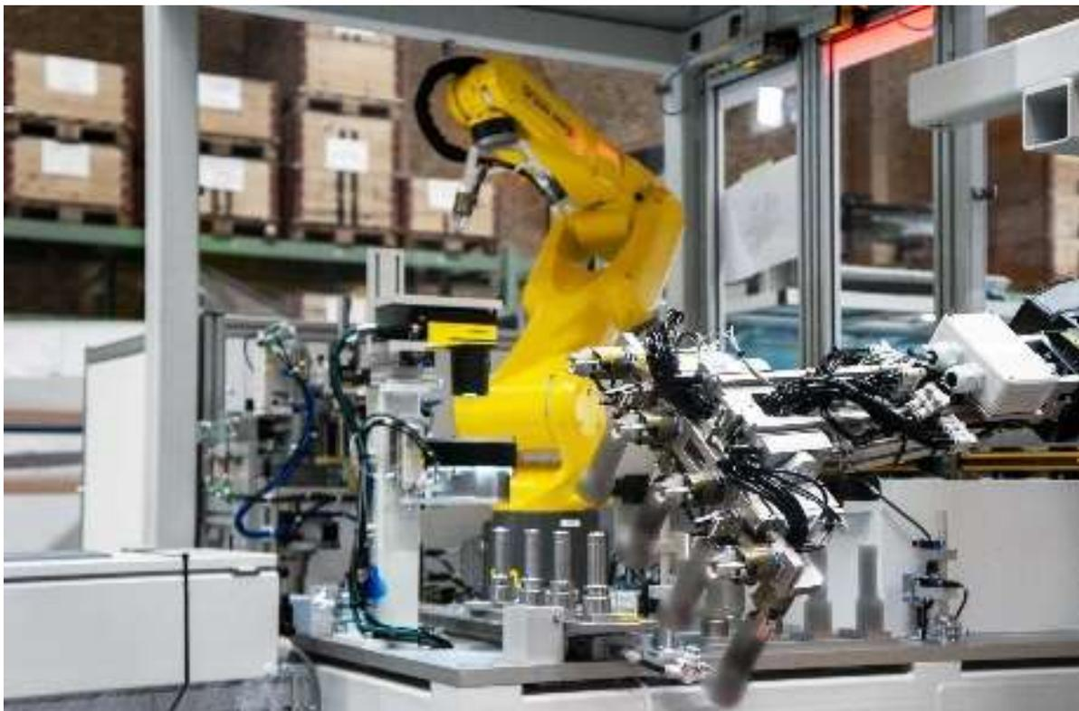
Le préhenseur multifonctions, juste avant la mise en place de quatre douilles nouvellement surmoulées sur les mandrins de contrôle de la station vision (Copyright: Robotec)
