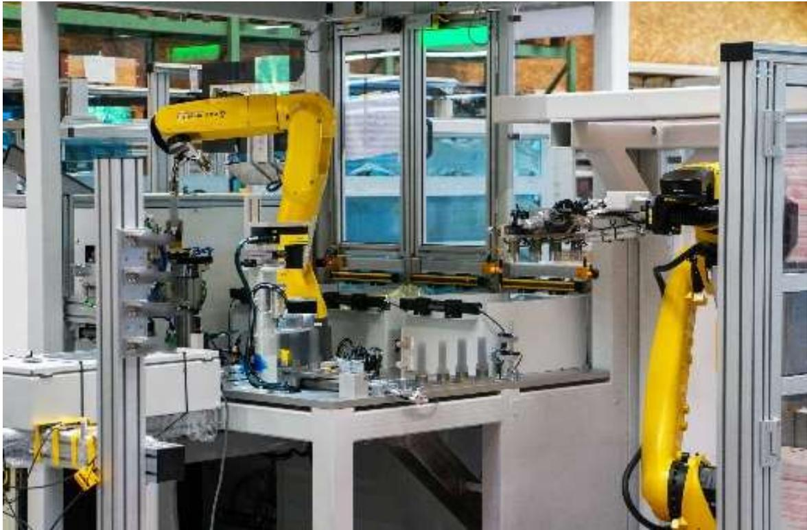
Quatre matrices fixées sur la colonne en profilé aluminium (à gauche sur l'image) représentent les noyaux du moule. Le robot „2“ (à droite) saisit quatre nouvelles ébauches avec son préhenseur multifonctions. Les composants surmoulés sont ensuite extraits. (Copyright : Robotec)
