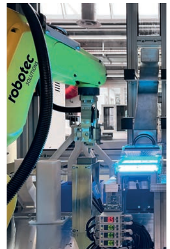
Feeder mit integrierter Lichtquelle und Vision-Kontrolle.
