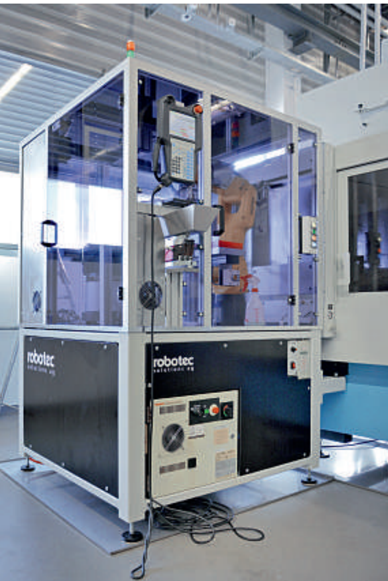
Die Zelle mit Bedienungspanel, darunter die Schublade für das Ausschleusen und unter dieser wiederum die Teilezufuhr zum Fördertopf. (Bilder: Robotec)
