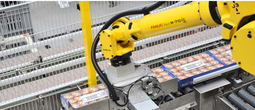
Der Robotergreifer wurde speziell für die Hero-Produkte entwickelt.
