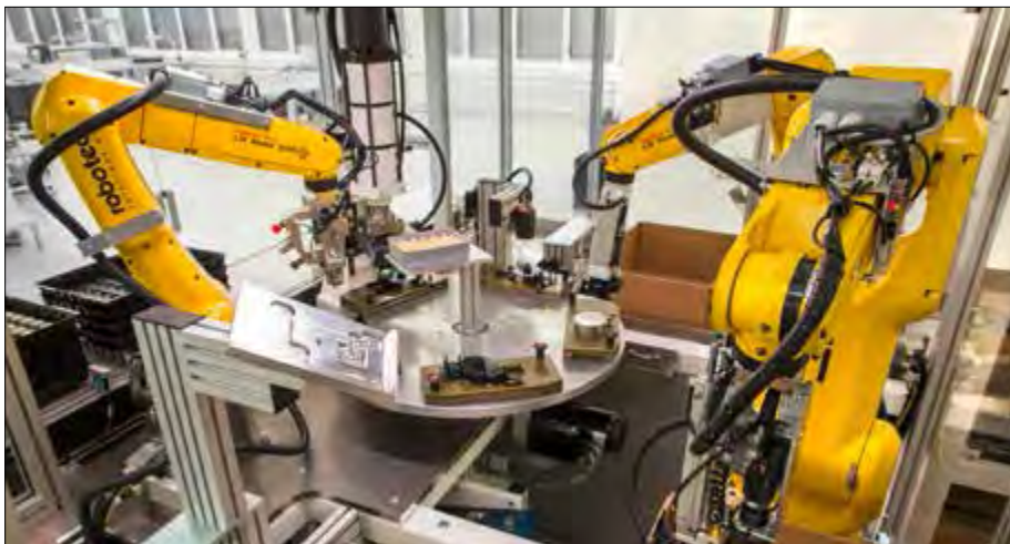
Die zu montierende Baugruppe ist Teil eines Antriebes für Lüftungssysteme in der Haustechnik.
