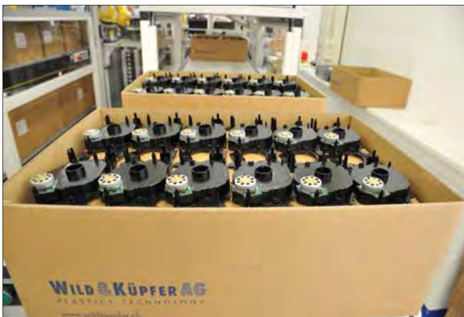
Fertig montierte Motorprinträger.
