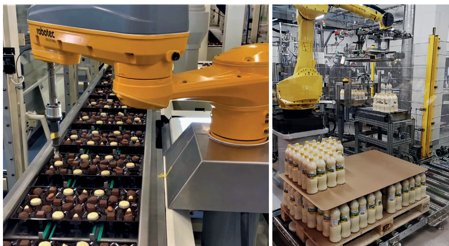
Die Roboter platzieren Pralinen in Blister oder stapeln Saltsaucenflaschen. (Bild: Robotec)
