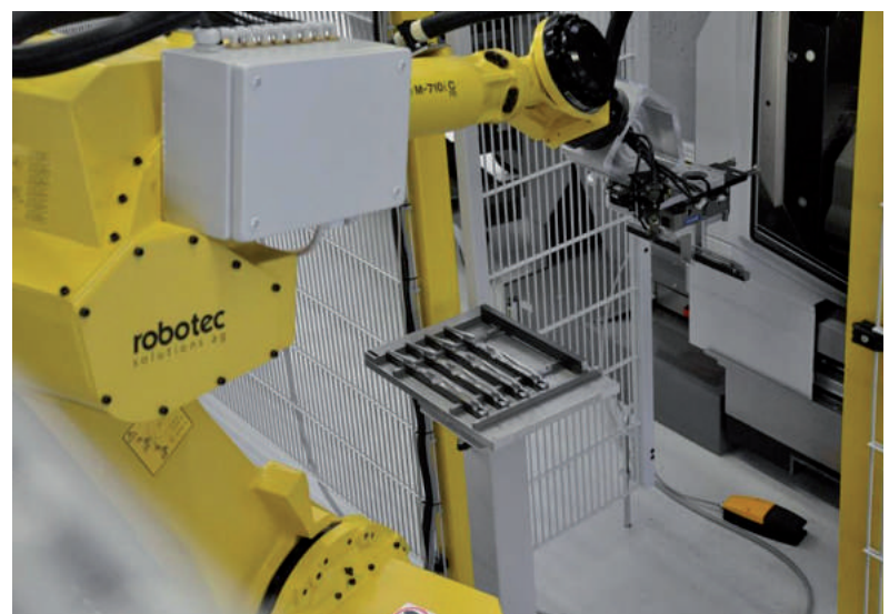
Bei der Hermle C 20 liegen die Teile lose auf einer Palette und werden vom Roboter nach einem Greiferwechsel einzeln in die Maschine eingewechselt.
