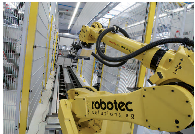
Der Roboter belädt und entlädt auf einer 8 m langen Verfahrachse drei Hermle Bearbeitungszentren.
