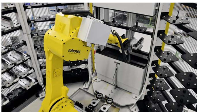
Der Fanuc Roboter M-710iC/50kg an der Beladestation. Vor seinem «Fuss» liegen die Einwechselgreifer bereit.
