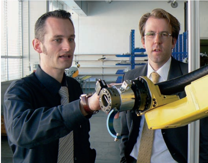
Die beiden Geschäftsführer begutachten ein eigenentwickeltes Wechselgreifersystem an einem Fanuc-Roboter.
