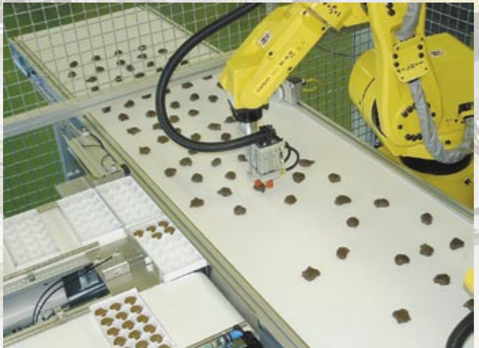
Die Arbeits-Aufgabe des Roboters: Er muss die chaotisch auf dem Förderband heran geführten Pralinen „orten“, greifen und in die Ausformungen der Trays ablegen.
